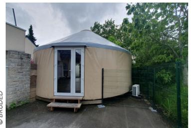
La nouvelle classe, séparée du bâtiment principal accueille les élèves de la classe bilingue français-breton. La yourte répond aux normes des bâtiments recevant du public (ERP). Elle est chauffée par une pompe à chaleur et a été facilement raccordée à l'électricité et à l'eau. Une mise en oeuvre très rapide d'environ 15 jours seulement, avec ici pas de terrassement spécifique à prévoir.
