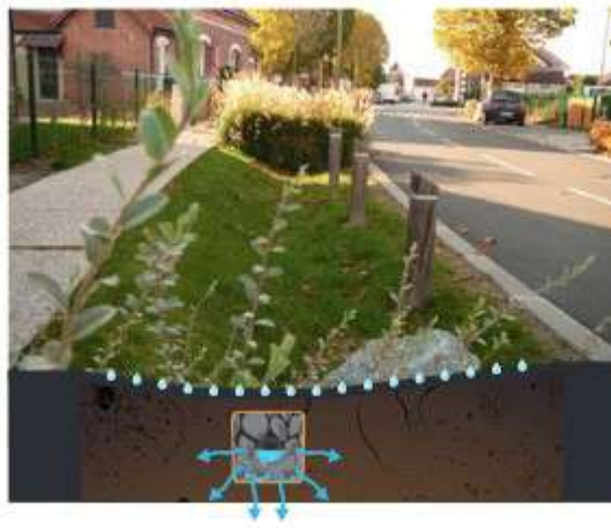
Noue avec tranchée d'infiltration
